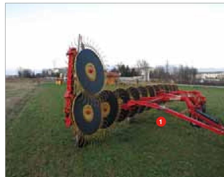
Per i trasferimenti un dispositivo idraulico permette di sollevare i primi due stellari anteriori riducendo la lunghezza del ranghinator e rendendo la macchina più compatta.
