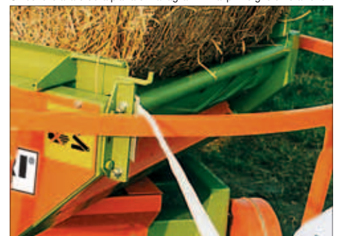
Un coltello a lato della piattaforma taglia il film al primo giro di rotazione.
