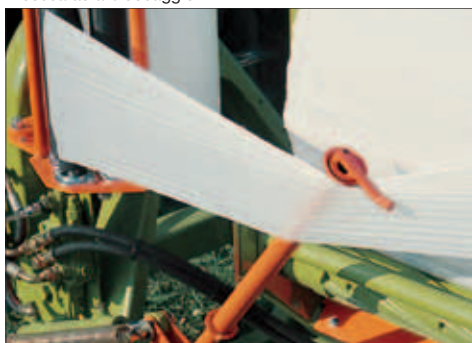
Discesa asta bloccaggio film.
