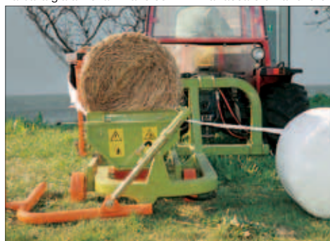
La palla già avvolta rimane con il film attaccato e trattenuto.
