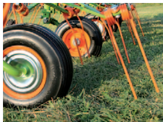
2 - Distanza ridotta dente-ruota
